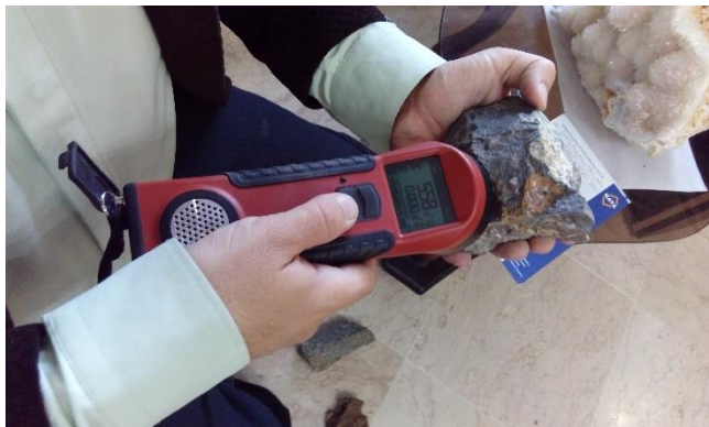
شکل ۳: دستگاه اندازه گیری رسانایی مدل TerraPlus KT-10.
