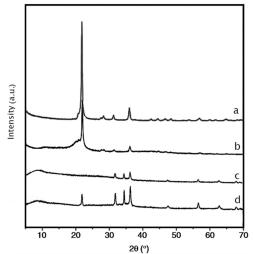
Figure 4. XRD patterns for (a) diatomite, (b) CDC, (c) MgAl-LDH, and (d) LDC.
