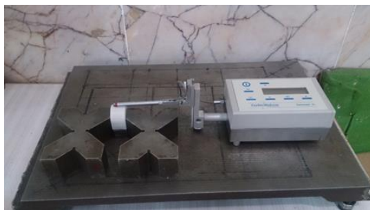
شکل ۵- آزمایش زبری سنجی با دستگاه Taylor Hobson
