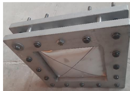
شکل ۲۷- پانل با هسته فوم پلی یورتان پس از انجام تست
