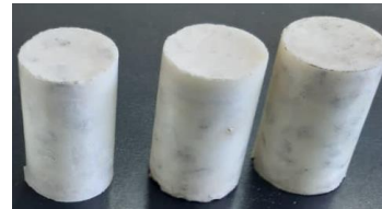
شکل ۲- نمونه‌های ساخته شده برای تست فشار
