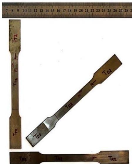
شکل ۹- نمونه‌های کشش تک محوری در سه راستا
